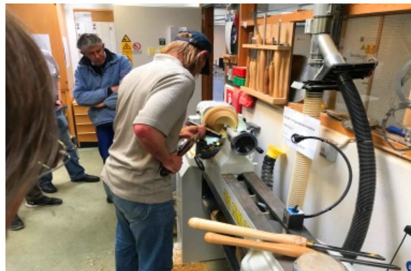
Der undervises i trædrejning af en skål på træværkstedet
